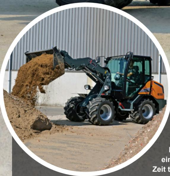
Ob bei einer hohen Anzahl von Ladespielen oder bei Einsätzen unter härteren Bedingungen, der hydrostatische 4-Rad-Antrieb mit automatischer Rexroth-Steuerung und die zuschaltbare 100%-Sperrung auf beiden 14-Tonnen-Achsen sorgen immer für genug Grip, viel Zugkraft und ruhige Bewegungen der Maschine. Mit einer Fahrgeschwindigkeit von 30 km/h können Kunden schnell von einer Baustelle zur anderen fahren oder Materialien in kürzester Zeit transportieren.
