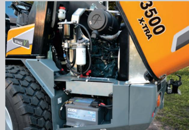
Es ist einfach, die regelmäßig wiederkehrenden Wartungsarbeiten beim G3500 durchzuführen, da die Wartungspunkte gut erreichbar sind. Filter, Hydrauliksystem und Motor sind aufgrund der leicht zu öffnenden Haube und anderer Wartungskappen direkt zugänglich. Somit wird sichergestellt, dass die täglichen Überprüfungen und Wartungsarbeiten schnell und sicher durchgeführt werden können.
