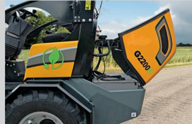
Es ist einfach, die regelmäßig wiederkehrenden Wartungsarbeiten bei den G2700E Modellen durchzuführen, da die Wartungspunkte gut erreichbar sind. Hydrauliksystem und Batterie sind aufgrund der leicht zu öffnenden Wartungskappen direkt zugänglich. Somit wird sichergestellt, dass die täglichen Überprüfungen und Wartungsarbeiten schnell und sicher durchgeführt werden können.
